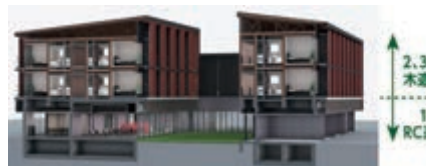
RC造と木造のメリットを適した場所で使い分けたハイブリッド構造
